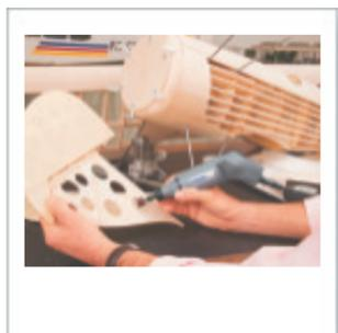
Используйте различные наждачные трубки 407 - 444 для зашкуривания и окончательной шлифовки
