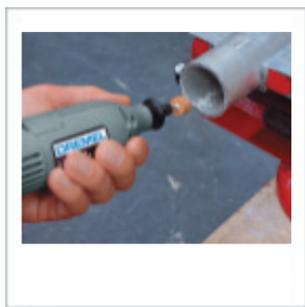
Для шлифовки острых краев выхлопной трубы Вашего автомобиля воспользуйтесь насадкой из оксида алюминия 952
