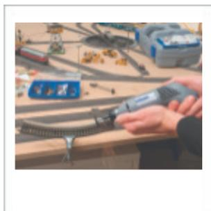
Армированные отрезные круги 426 могут использоваться в различных работах, связанных с резкой, например, для нарезки рельсов игрушечной железной дороги нужного размера
