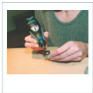
С помощью щетинной щетки 403 Вы можете удалить пыль и грязь с дорогостоящих металлических деталей
